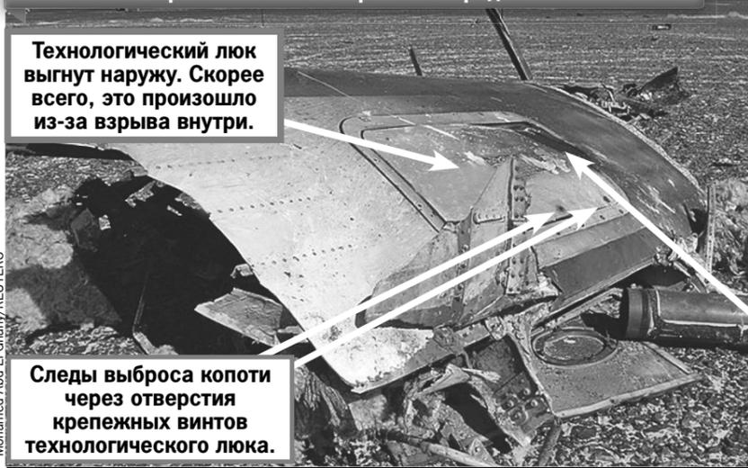
Технологический люк выгнут наружу. Скорее всего, это произошло из-за взрыва внутри.
